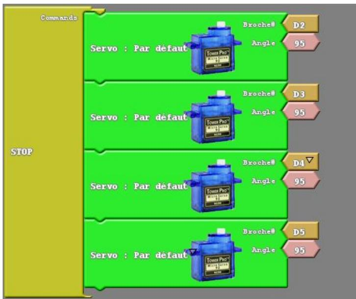
La valeur pour permettre aux servomoteurs moteurs de s'arrêter est 95.
