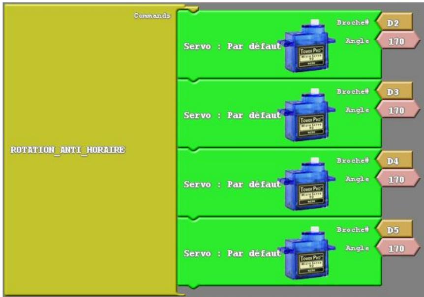
La valeur pour permettre aux servomoteurs moteurs de tourner dans le sens antihoraire est 170.
