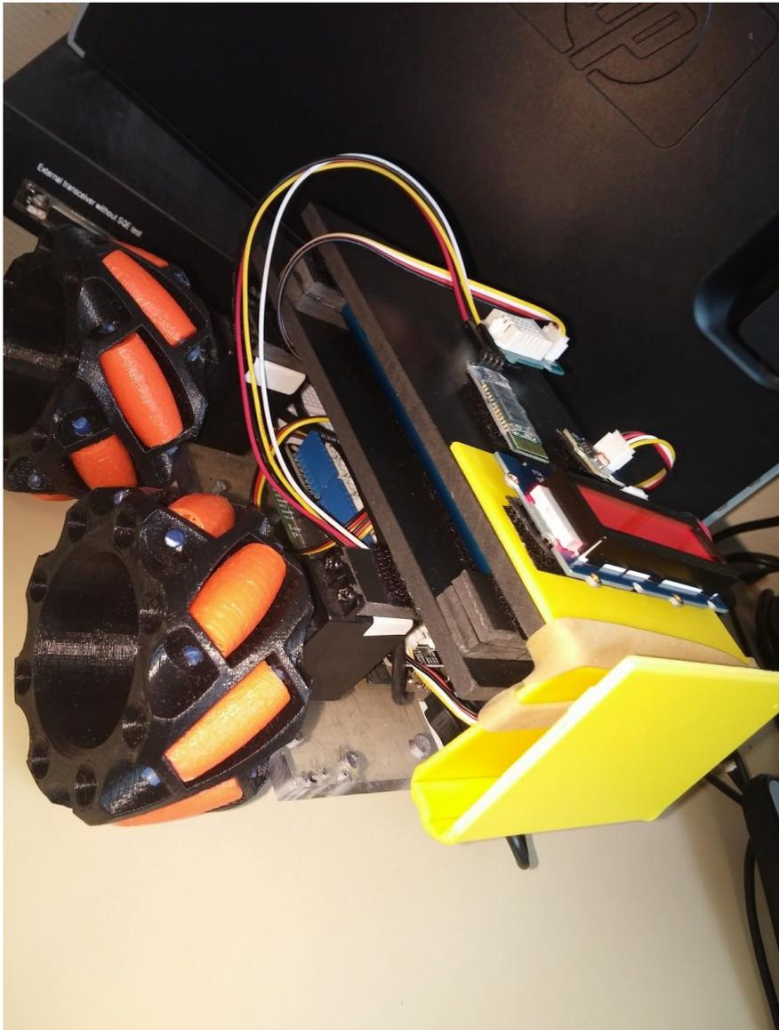
Sur cette photo on peut voir un afficheur LCD ainsi que les capteurs : d'humidité, de lumière et de température .
