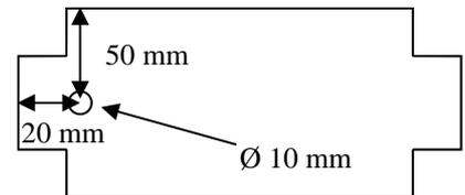
Pliage avec la thermo plieuse à 50 mm de longueur et 90 °
