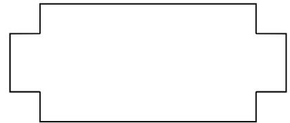
Percer la plaque avec un foret de  $\varnothing$  10 mm à 50mm de largeur et 20 mm de longueur.
